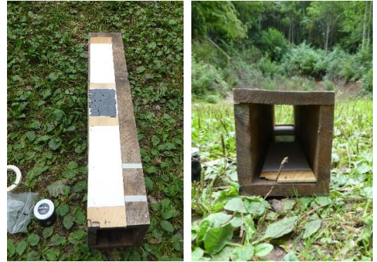
Abb. 27 | Spurentunnel und das Brett mit Stempelkissen (schwarz) und den Papierstreifen
